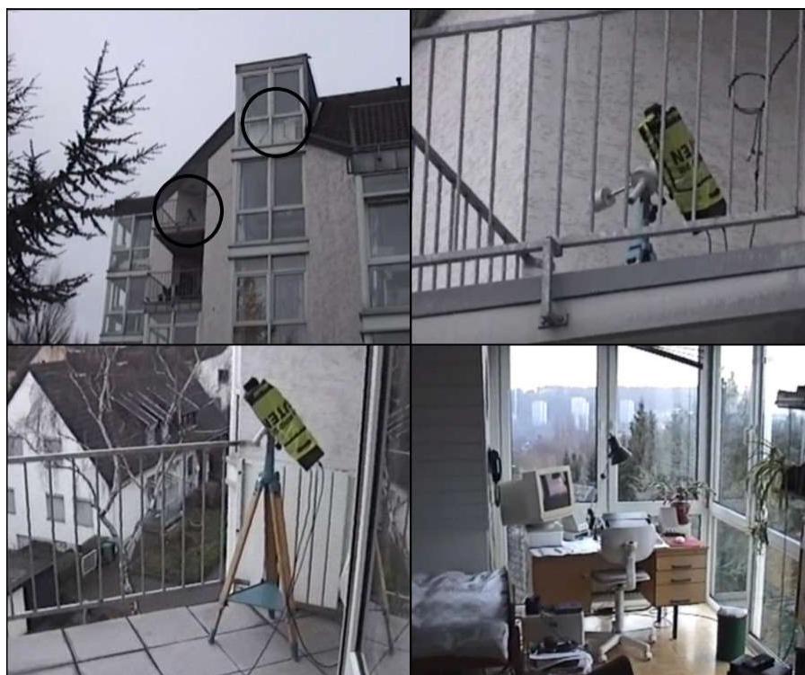
Abbildung 1: Der Start des IMO Video Meteor Network in meiner Aachener Wohnung im März 1999 (oben links). Die Kamera AVIS wurde auf dem Balkon aufgestellt (oben rechts, unten links) und fütterte das Videosignal live in den Auswerterechner (unten rechts).
