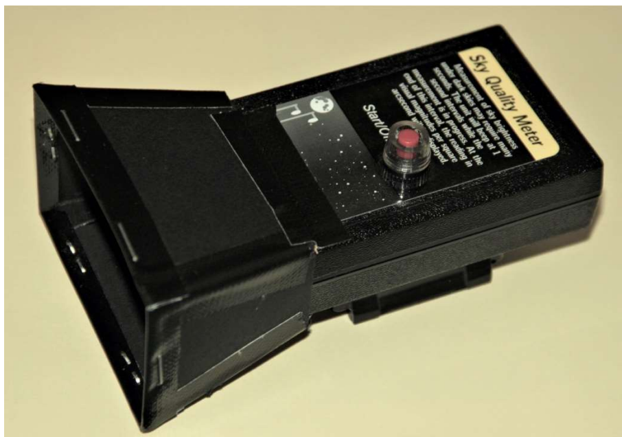
Abb. 1: Modifiziertes SQM mit Blende
