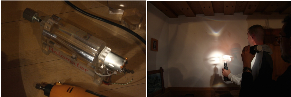
Aufbau des Halomators und Einsatz bei der Simulation von Parrybögen. Fotos. M Großmann
