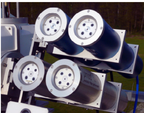
Abb. 5: Präzisionsfiltrerradiometer zur Bestimmung der Aerosoloptischen Dicke.
