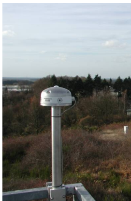
Abb. 1: Modifizierte MOBOTIX-Überwachungskamera zur Wolkenbeobachtung auf der Strahlungsplattform in Lindenberg
